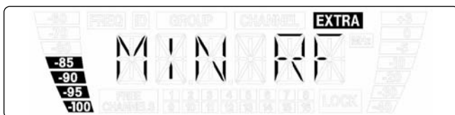
Esempio 2: Livello RF minimo -85 dB.
