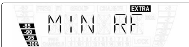
Exemple 2 : niveau HF minimum -85 dB.
